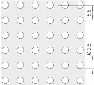
**Rg2516** | Ø 2,5 mm | 16 % freier Querschnitt
