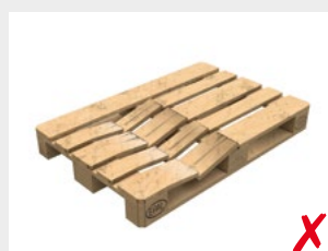
Schäden an mehr als 3 Bauteilen
