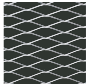
Mesh R 60x20 70 % freier Querschnitt Strangbreite 3,0 mm Materialstärke 1,0 mm
